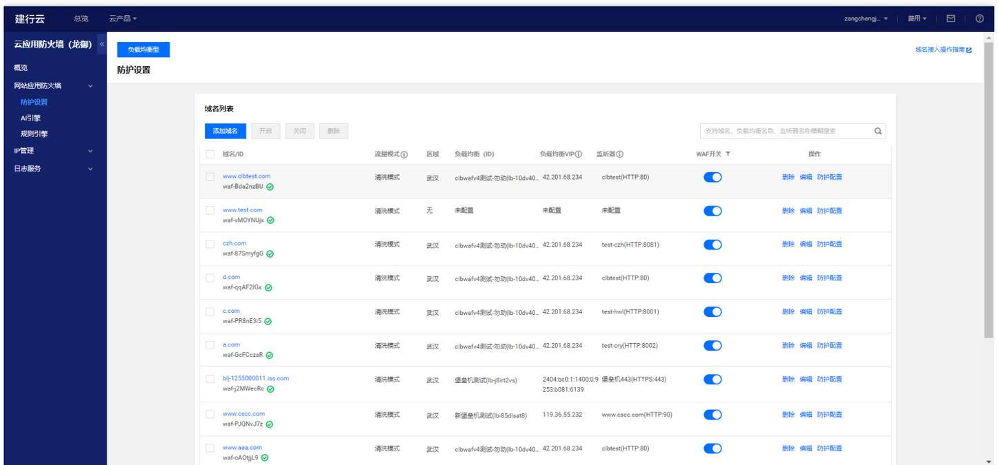
6、点击【防护配置】按钮，进行waf防护配置。【流量模式】选择为“清洗模式”，【Web基础防护】选择为“拦截”，高级设置下的【恶意文件检测】设定为“否”，【防护等级】选择为“严格”，【AI引擎】选择为“观察”（在观
